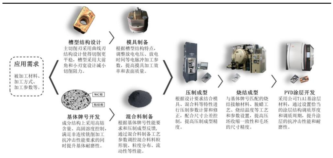
图14：数控刀具工艺流程示意图
