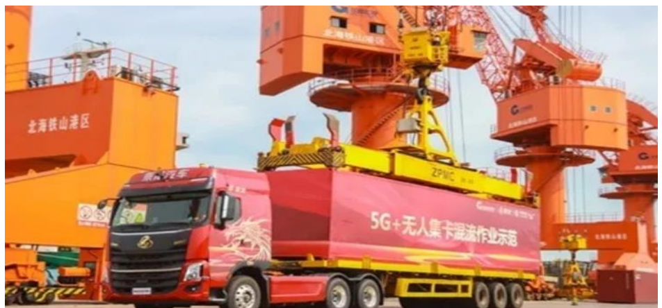
图41：东风柳汽乘龙卡车在北海码头进行5G+无人集卡作业
