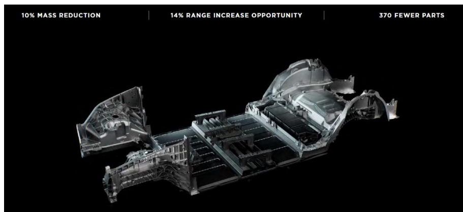
图 17: Tesla 汽车地板一体压铸优势
