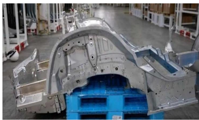
图 16: Model Y 后底板采用一体压铸成型，铸件少
