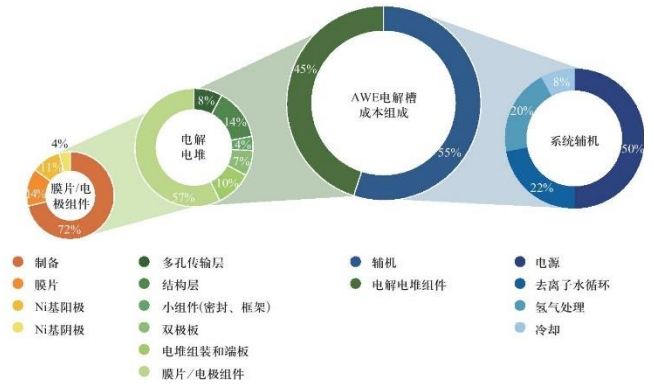
图29：1MW 碱性电解槽的成本组成主要包括电解电堆组件及辅机
