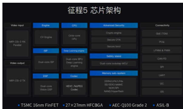
图4：地平线征程5芯片架构
