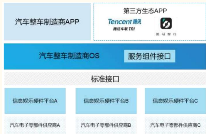
图表 34: 信息娱乐系统软硬件分离架构设计
