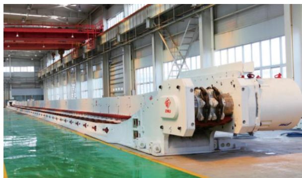
图 16：铸焊结构刮板输送机
