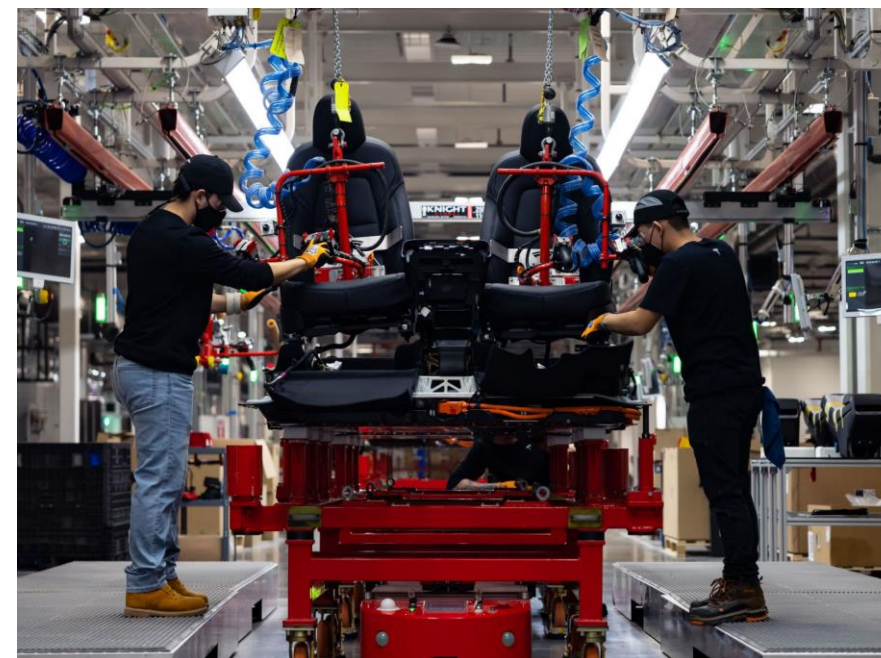
图：德州工厂中座椅与4680 CTC电池包直接连接
