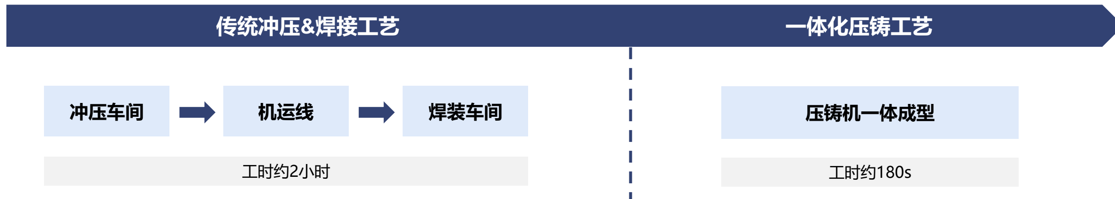
图：传统冲压工艺/一体化压铸工时对比
