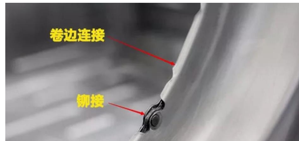
图：奥迪A8卷边连接、铆接工艺
