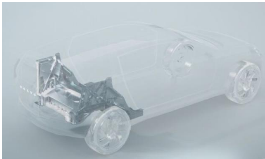
图：沃尔沃下一代纯电车型一体式压铸车身（概念图）
