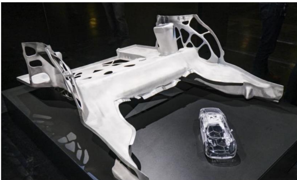
图：奔驰仿生工程结构部件
