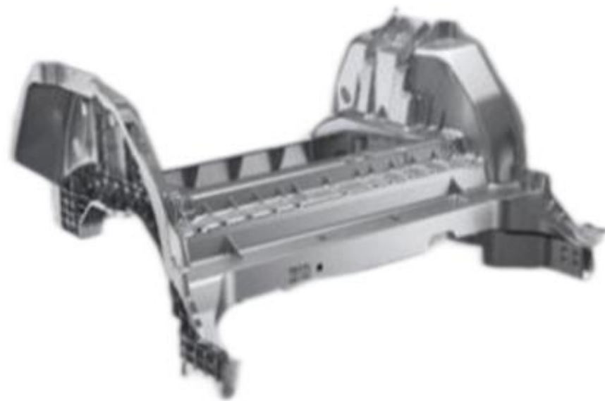
图：拓普集团下线7200T一体化压铸车身后舱
