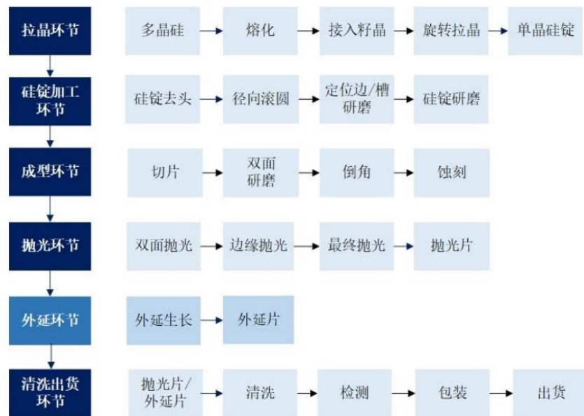
图11：半导体硅片的制作流程较长，不同用途的硅片涉及的工艺也不尽相同
