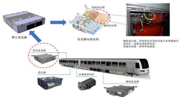
图24: 公司产品在高铁牵引供电系统的应用
