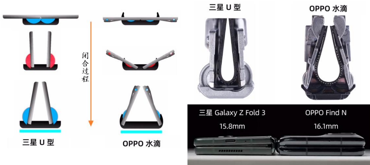
图表 20：水滴型铰链通过更复杂结构实现了更佳性能
