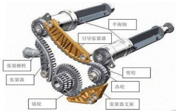
图 39：发动机平衡轴结构
