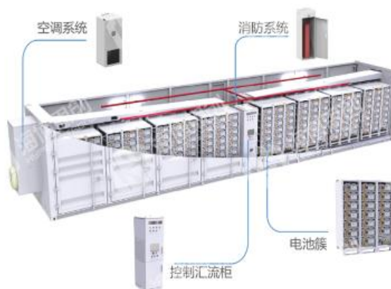
图 24：风冷储能系统结构示意图
