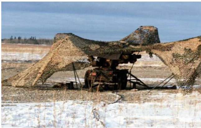
图17: 传统遮障伪装: 采取伪装网的防空导弹发射装置
