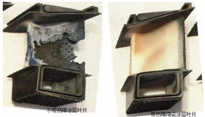
图28：热障涂层可大幅提升发叶片的可靠性和服役寿命
