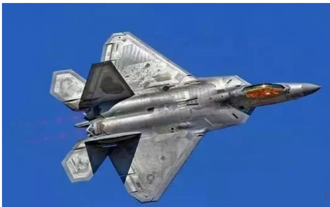
图40: F22 战斗机表面涂料修补痕迹实例
