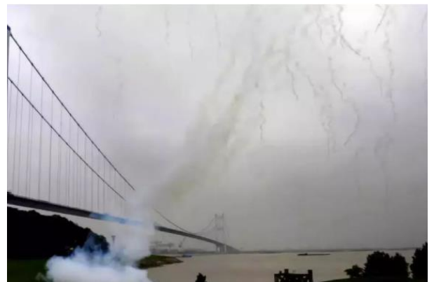
图16：通过发射锡箔弹对重要设施进行雷达伪装实例
