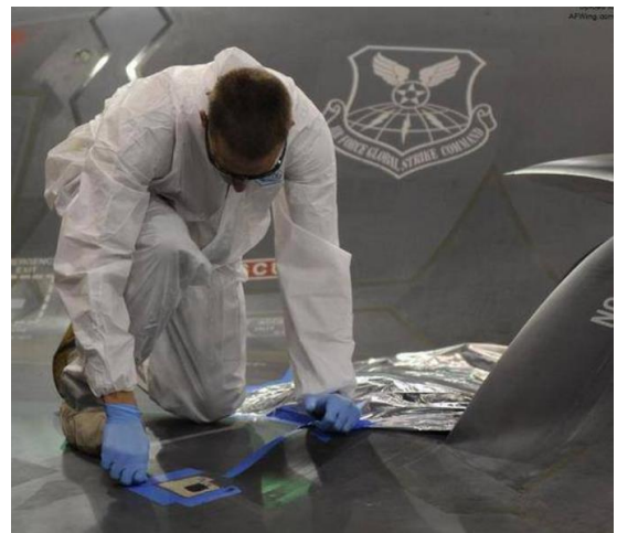
图41: B2 轰炸机隐身涂层维护实例
