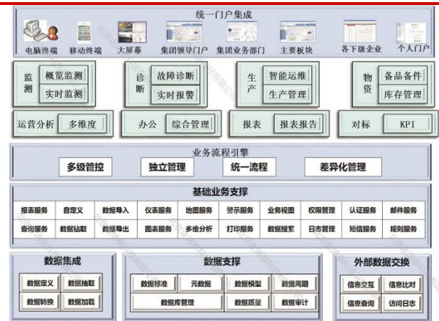
图表 7 新能源电站智能运维管理系统
