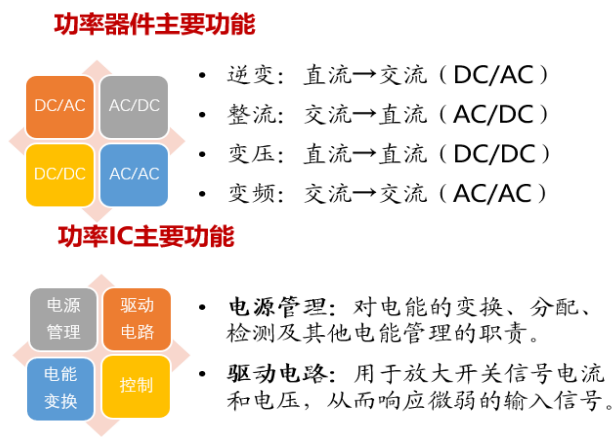
图 8：功率器件和功率 IC 的主要功能
