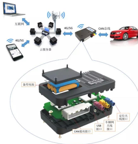
图 17: T-Box 实现功能与拆解
