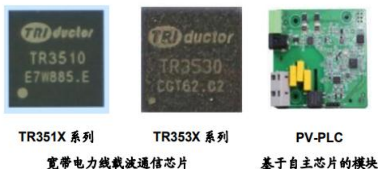
图 5：宽带电力线载波通信芯片与基于自主芯片的模块
