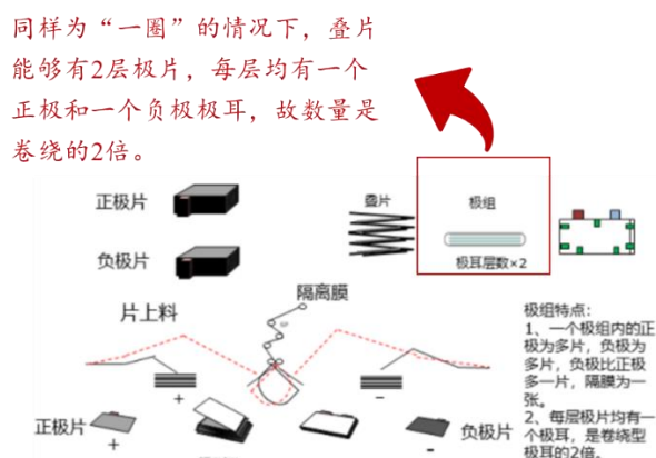
图3：叠片的极组成型工序
