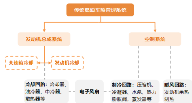
图 15：传统燃油车热管理系统示意图
