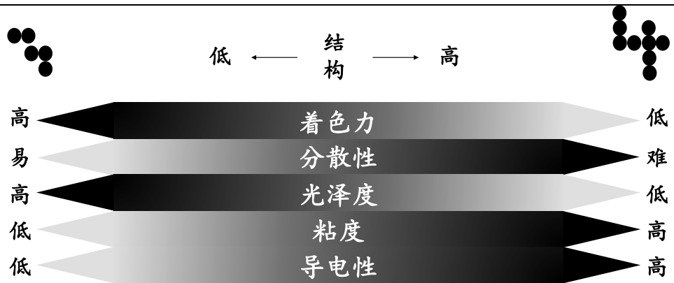
图17：导电炭黑结构值越高，导电性越高
