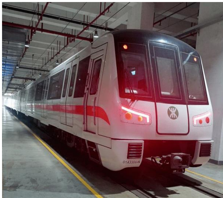
图表 34 中车株洲所自主研发的搭载全碳化硅牵引逆变器的列车
