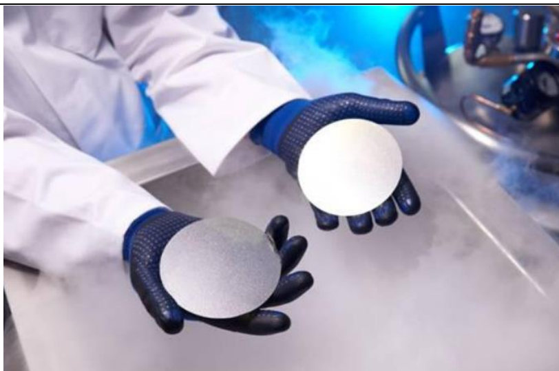
图表 69Cool Split 技术切割出的晶圆
