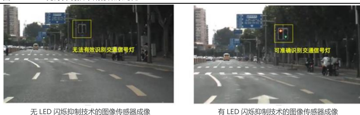
图 56：LED 闪烁抑制技术成像效果对比
