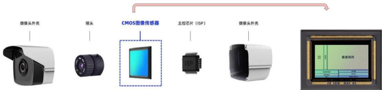
图 20：CMOS 图像传感器在摄像头中的应用以及 CMOS 图像传感器示意图
