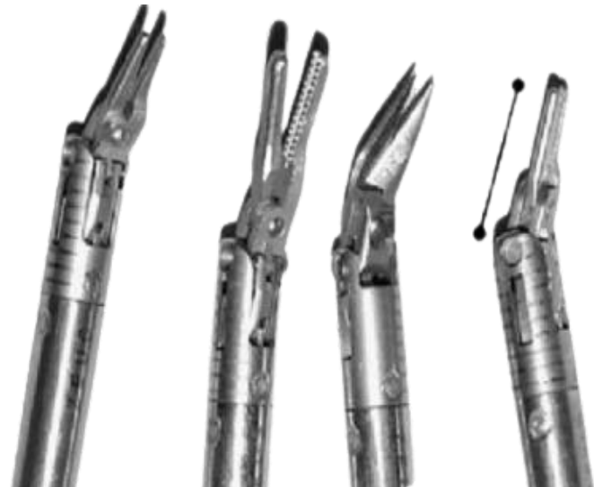
ZEUS手术机器人机械臂多种手术钳
