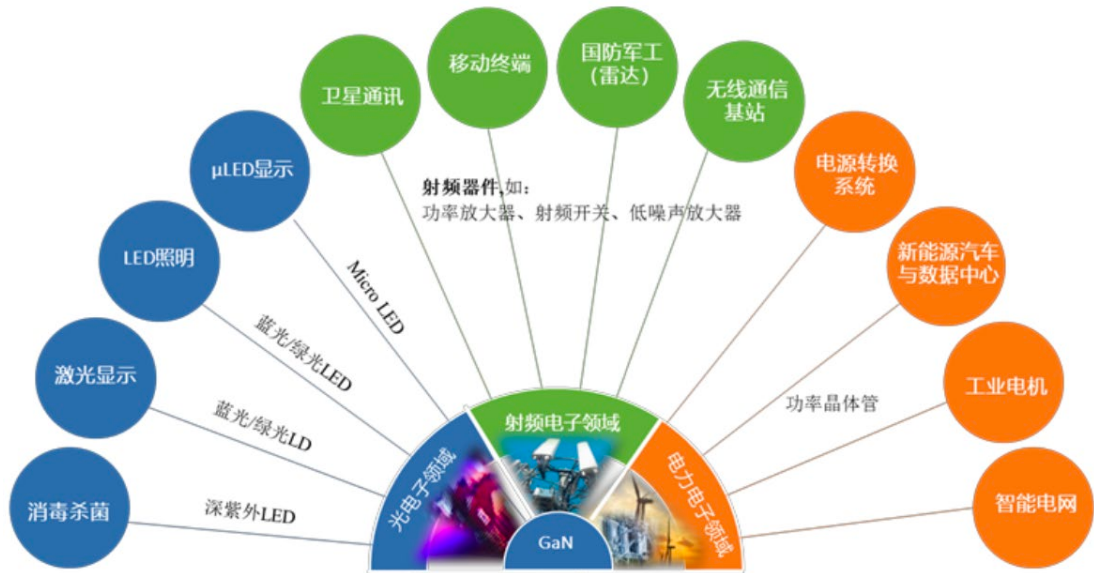
图表 15 GaN 主要用于光电子、射频电子及电子电力领域
