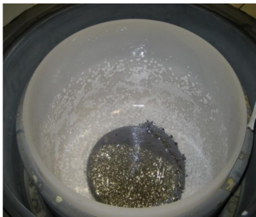
图表 34. 石英坩埚析晶现象（白色物质为析出的晶体）
