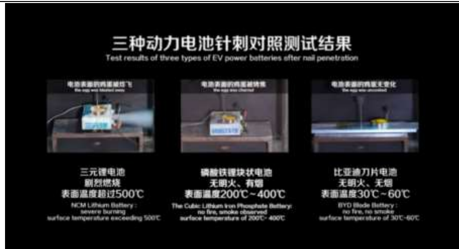
图118 动力电池针刺对照测试：刀片电池安全性无可比拟
