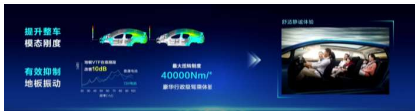
图68 比亚迪 e 平台 3.0 整车刚度提升
