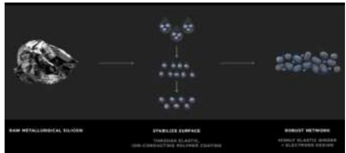
图129 4680 电池负极将采用硅基负极材料
