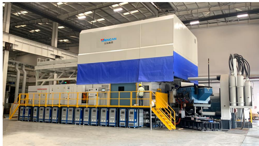
图19：力劲DREAMPRESS 9000T超级智能压铸单元
