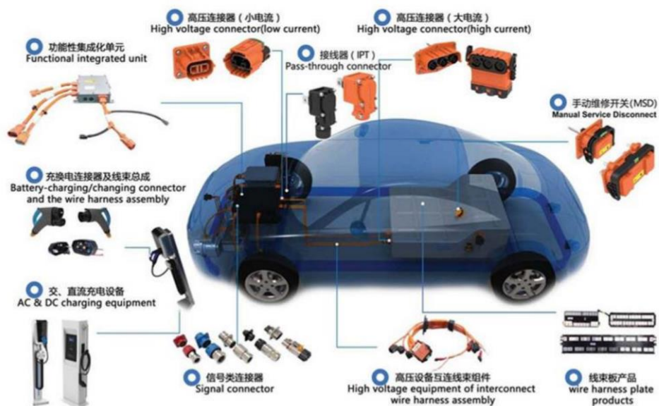
图 28: 连接器在新能源汽车领域主要应用于充电系统和整车系统
