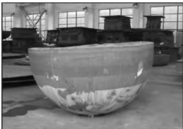
图表 97 深潜器和舰船的耐压 Ti80 合金锻坯
