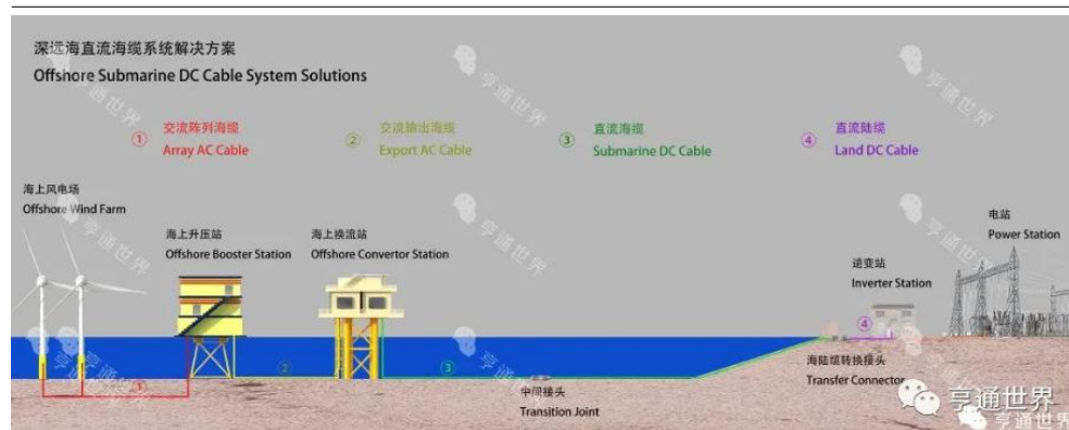
图 40：公司深远海柔性直流海底电缆解决方案
