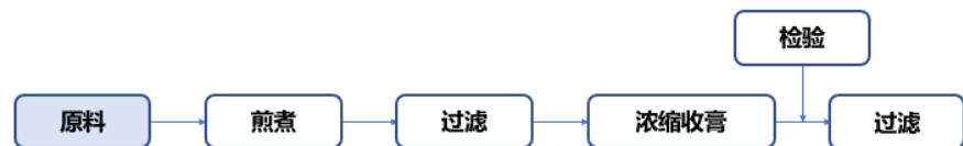
图表 8 公司兽用中药提取工艺流程
