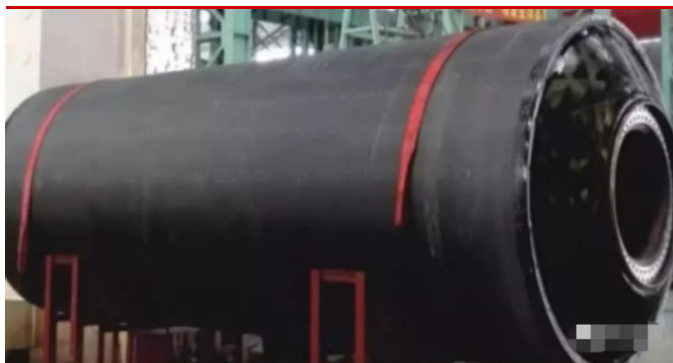
图 21 纤维缠绕复合材料壳体整体式固体发动机
