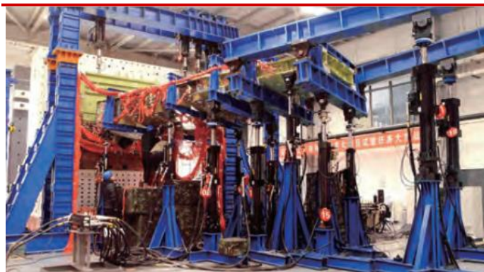
图 16 C919 复合材料机翼研制攻关项目典型盒段静力和损伤容限试验
