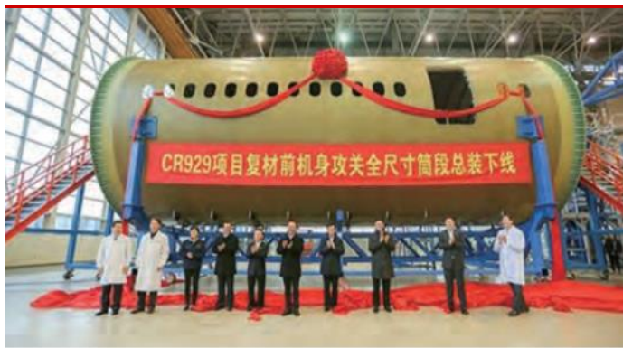
图 17 CRJ929 飞机前机身攻关复合材料全尺寸筒段
