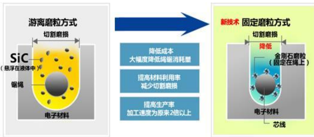
图 9：游离砂浆切割与金刚线切割方式对比
