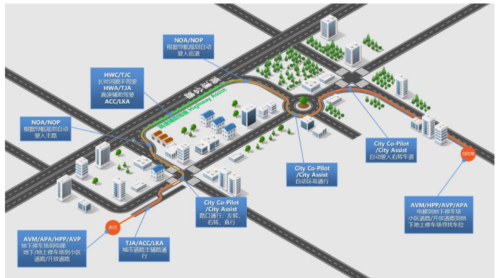
图26：公司可以提供 L0-L2.9 级自动驾驶软硬一体全栈式解决方案
