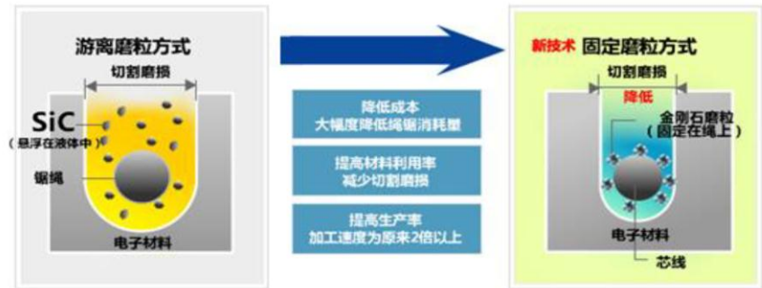
图表 14：游离磨料砂浆切割和金刚石线切割方式示意图
