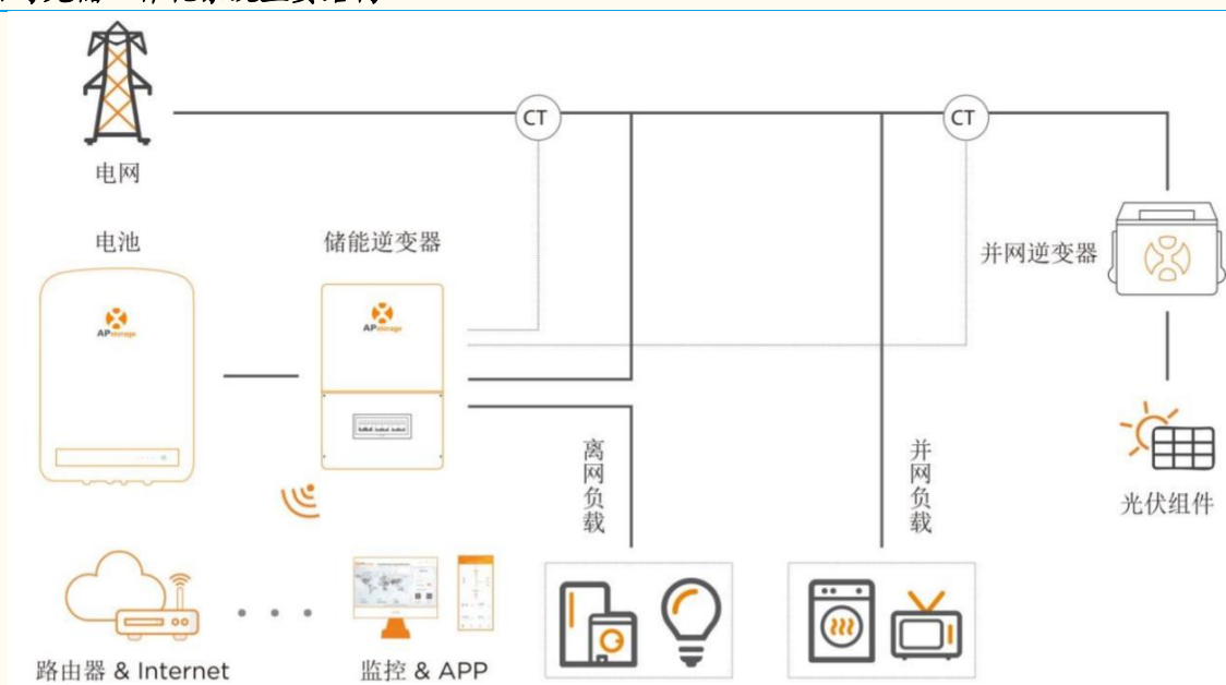
图表 31：公司光储一体化系统主要结构
