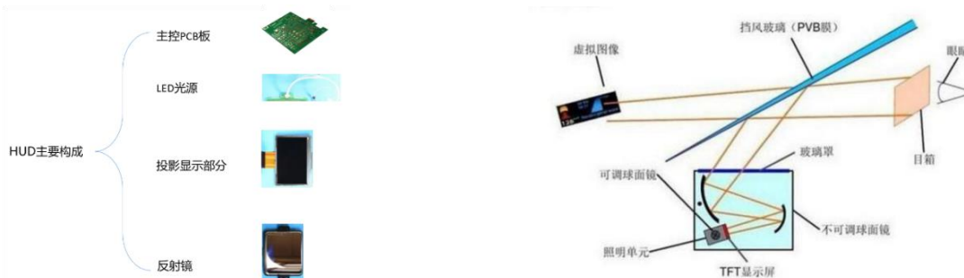
图 50: HUD 主要构成及工作原理
