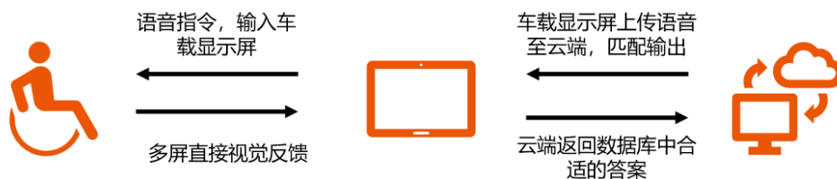
图 42：车载显示屏参与 HMI 系统示意图
