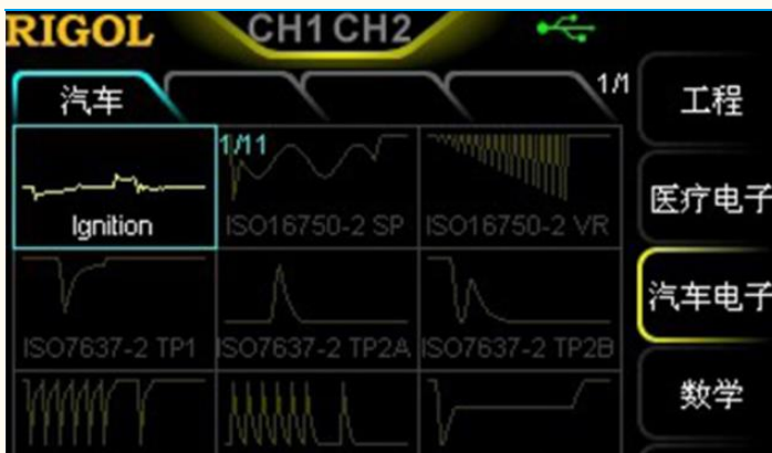
图表 51：公司车用激励信号模拟解决方案
