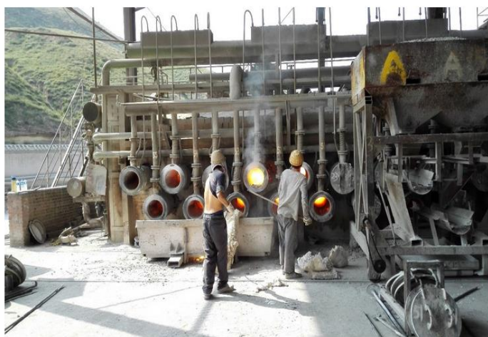
图 14：横罐炼镁装置
