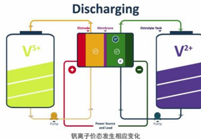
图34：钒电池工作原理图（放电过程）
