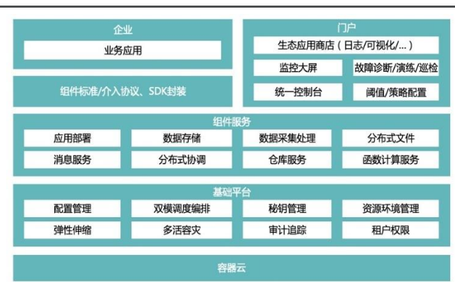
图 74：恒生电子云原生 PaaS 底座架构图
