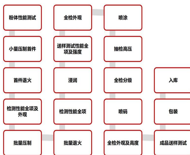
图 4：软磁粉芯制备流程
