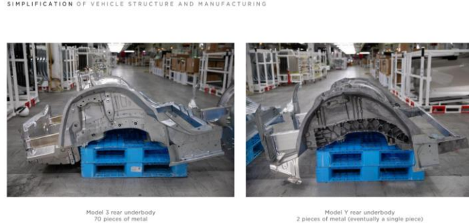
图 13：特斯拉一体化压铸后地板实物图
