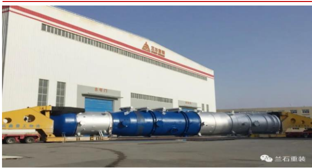
图 45：煤制氢装置余热锅炉
