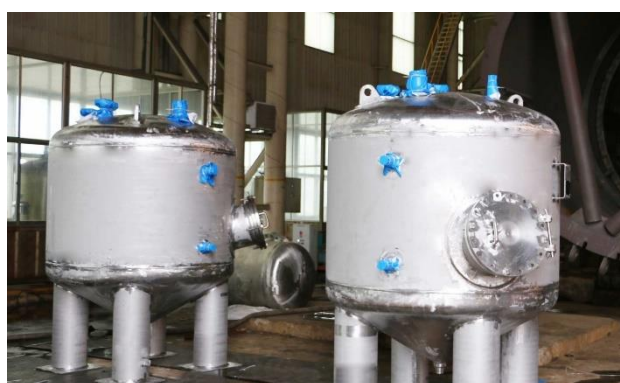
图 38：旋流器泥浆接收槽
