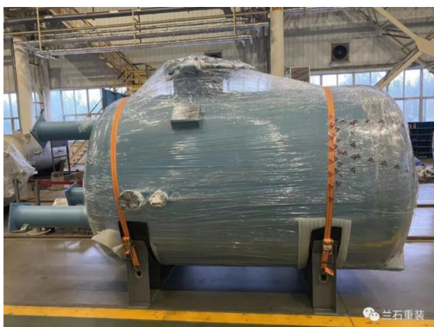
图 35：压缩空气缓冲罐
