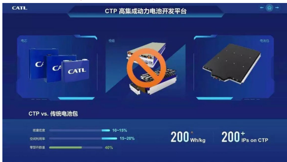
图：宁德时代第一代CTP VS 传统电池包
