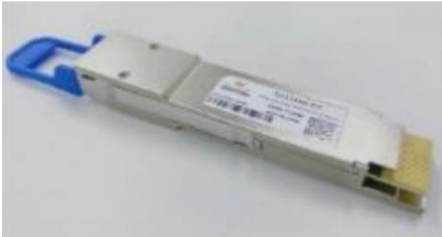
图52：量产版 400G QSFP-DD DR4 硅光模块
