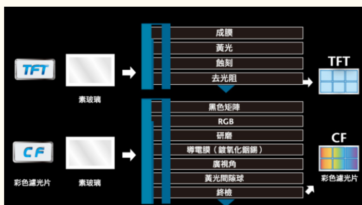
图表 50：TFT 基板与 CF 基板的制作流程
