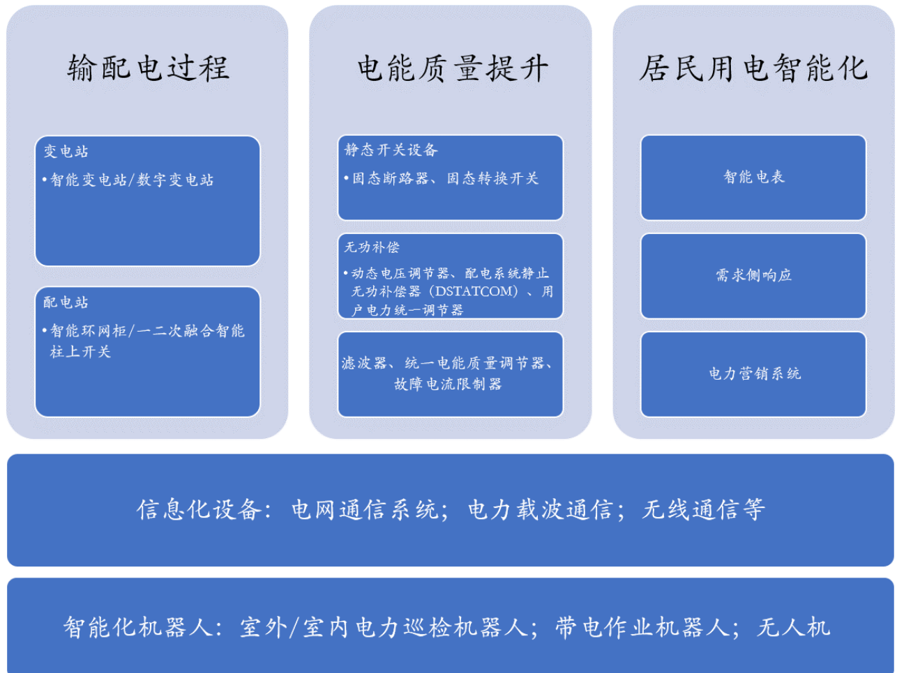
图 109：智能化改进的电力设备
