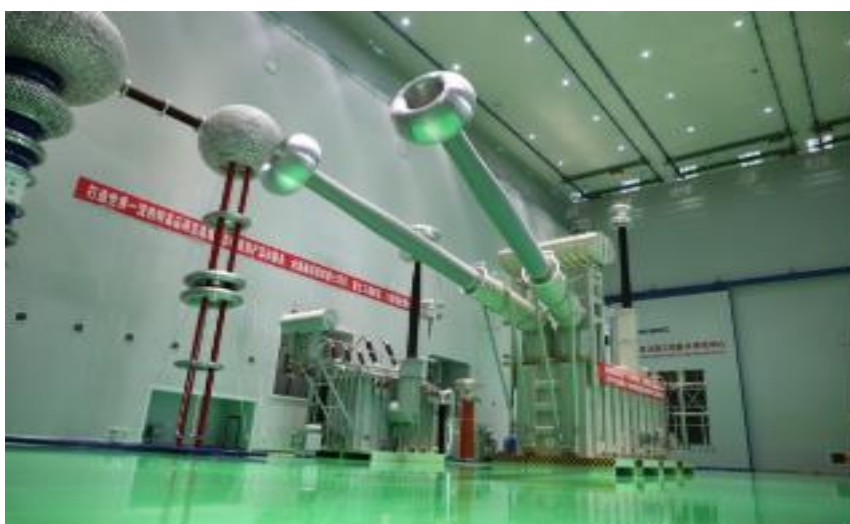
图 88：换流变压器示意图
